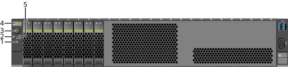
图 5-9 8x2.5 英寸硬盘配置前面板指示灯和按钮
