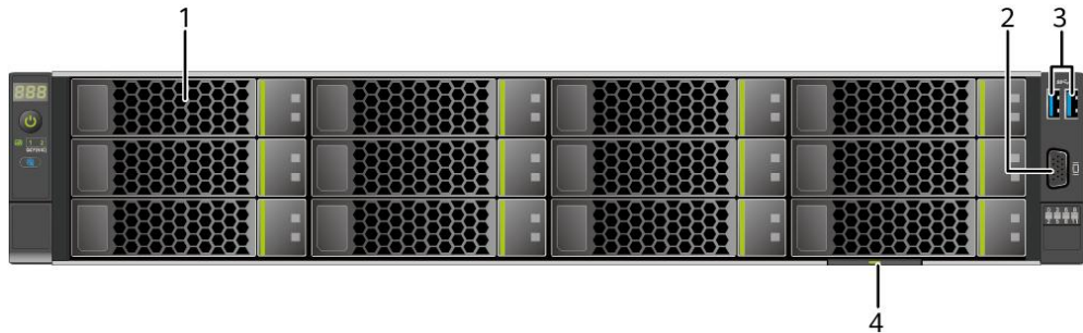
图 5-1 12x3.5 英寸硬盘配置前面板组件
